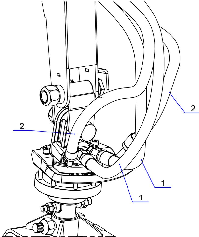
LISTA DE PIEZAS - MANGUERAS HIDRÁULICAS, NO. DE PIEZA 60-021
